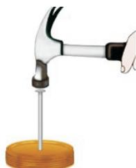
1. Abre un orificio en la tapa del frasco. Saca la tapa del frasco y marca el centro. Con un clavo ábrele pequeños agujeros, hasta conseguir hacer un orificio central del diámetro del niple.
