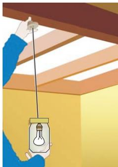
4. Destornilla la tapa del techo, si la tiene, saca los cables y sepáralos algunos cm. Pela aproximadamente 1 cm. de cada cable, tanto del techo como los de tu lámpara colgante. Enrolla los filamentos de cobre sobre sí mismos. Une el extremo de uno de los cables del techo a uno de tu lámpara; recubre con cinta aisladora. Repite lo mismo con los otros dos cables. Apreta los cables contra el techo y vuelve a atornillar la tapa.
