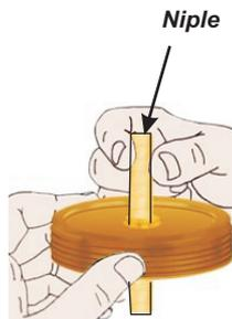
2. Instala el niple en la tapa. Ajusta el niple a la tapa, cuidando que la lata quede apretada firmemente entre los tornillos del niple.
